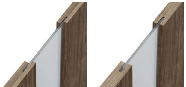
łączenie z szybą „na kant” skrzydło przylgowe
