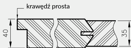
Przekrój poziomy drzwi Tizano, Tixa
