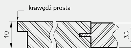
Przekrój poziomy drzwi Scala i Trevi
