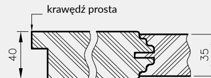
Przekrój poziomy drzwi Scala i Trevi
