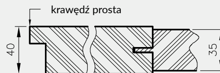
Przekrój poziomy drzwi Ena, Verano, Emena i Triesta (przekrój na wysokości ramiaka przy dużej szybie)
