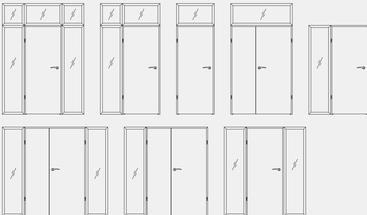
Możliwe konfiguracje naświetli/doświetli
