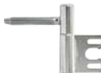
zawias czopowy typ M do ościeżnicy metalowej 15/18,45
